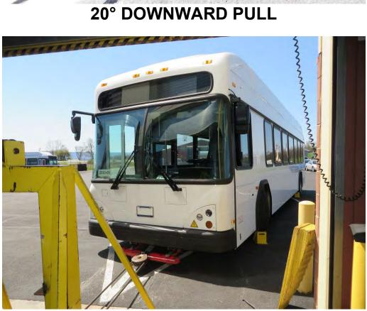
**5.3 STATIC TOWING TEST**
