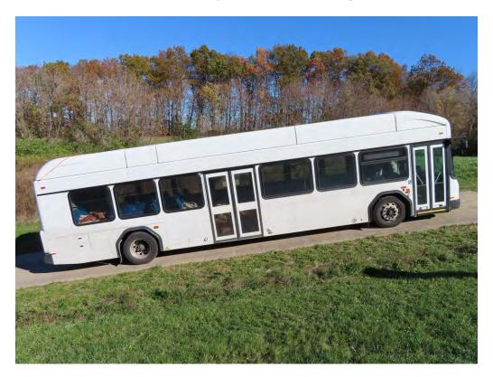
PARKING BRAKE TEST PARKING BRAKE HELD FOR 5 MINUTES IN BOTH 20% UP AND 20% DOWN POSITIONS
